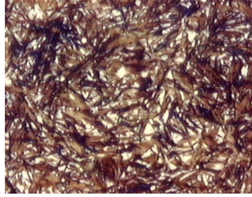
Bild 14 - 100Cr6 gehärtet und angelassen 1000:1 Grobadeliger Martensit Karbide aufgelöst Restaustenitgehalt \approx 25-30\% , \approx 60 HRC Härtegefüge nicht i.O.
